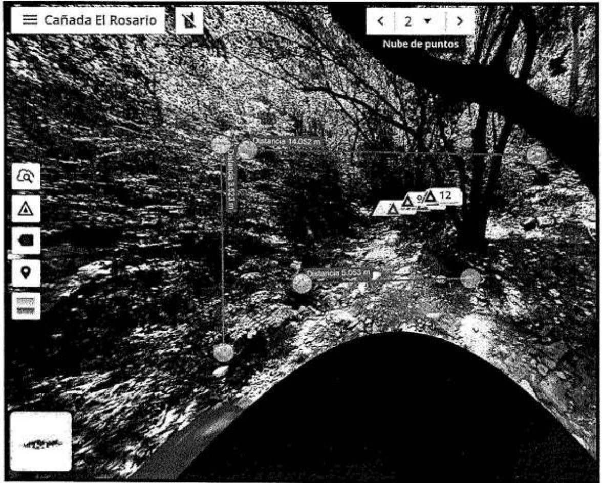
De la imagen anterior se observa que resulta una altura de 3.52 metros lineales, un ancho de arrastre de cañada de 5.03 metros lineales, así como un ancho entre los hombros de la parte alta de la cañada de 14.052 metros lineales.
